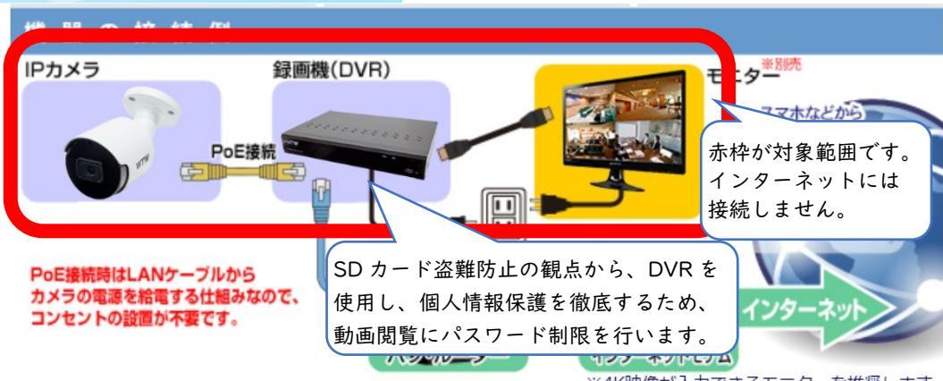
本機種は PoE 接続<sup>1</sup>という、LAN ケーブルのみ接続を行えば電源供給と通信が行える仕組みが採用されており、町内会館への穴あけ施工が最小限となるのも特徴です。SD カードへの保存もできますが、個人情報保護の観点から施錠ができる事務室内に録画データを保存するものとします。またセキュリティ上の観点からインターネットには接続しません。
